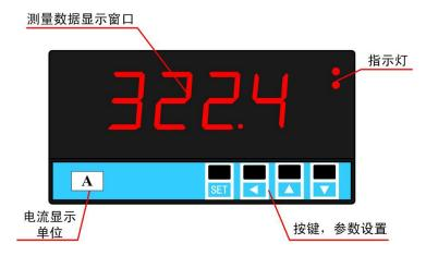
**说明**:四位LED数码管实时显示电流测量值,上图显示电流测量值为322.4A;两个指示灯分别为AL1,AL2为两路报警指示灯,报警继电器动作时,对应指示灯亮,报警继电器恢复,对应指示灯灭。
